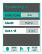
C'est ici que sont définis les paramètres de la pompe doseuse pH lorsque l'option pH est utilisée.
