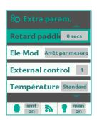
Le réglage "Retard paddle" permet de temporisé le déclenchement de l'alarme de débit FL1. Cela permet d'éviter les déclenchements intempestifs dus à une réponse courte, liée au système, de l'interrupteur à palette externe ou du capteur de gaz. Veuillez noter que ce délai n'affecte que le FL1 provoqué par l'interrupteur à palette, et non le FL1 provoqué par le capteur de gaz de la cellule.
