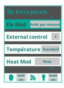
Le comportement de la cellule de production de chlore et de toute pompe doseuse connectée pour la désinfection est défini ici lorsque l'option Redox est utilisée.
